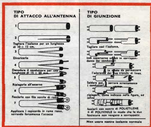
Fig. 11 - Modalità da seguire per effettuare la giunzione o l'attacco all'antenna di linea con isolante cellulare continuo.
