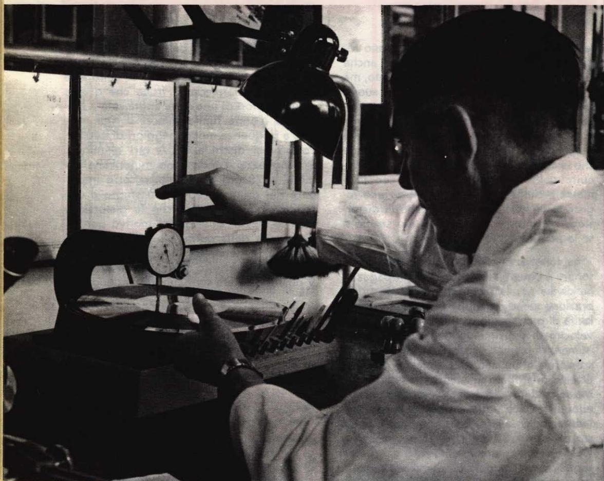
Controllo dello spessore di una matrice mediante micrometro.
