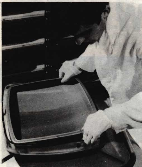
Fig. 2 - La maschera viene collocata in posizione davanti allo schermo.
